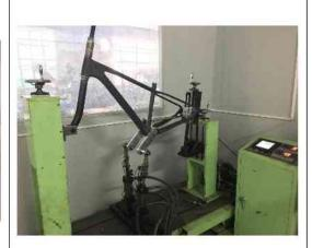
4. Horizontal fatigue test 水平拉力疲劳测试
