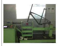
6.Vibration fatigue test 震动疲劳测试
