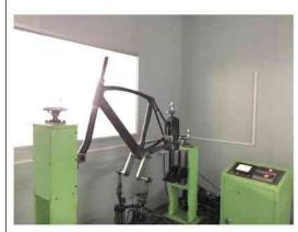
6.Vibration fatigue test 震动疲劳测试
