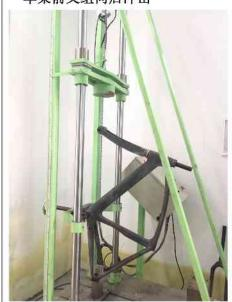
4. Horizontal fatigue test 水平拉力疲劳测试
