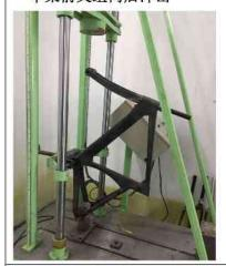
4. Horizontal fatigue test 水平拉力疲劳测试
